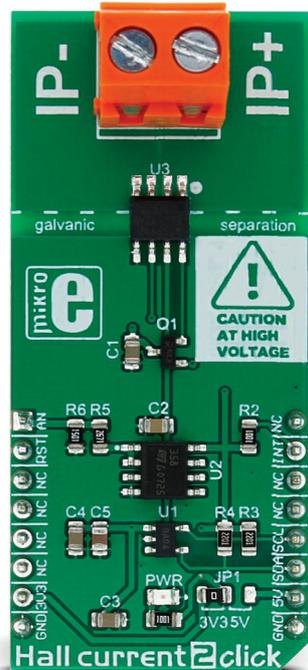
• B.- Le module de mesure de courant Click Hall Current 2 de MikroElektronika est compatible avec le bus d'extension mikroBUS que l'on trouve notamment sur l'Explorer 16/32.
