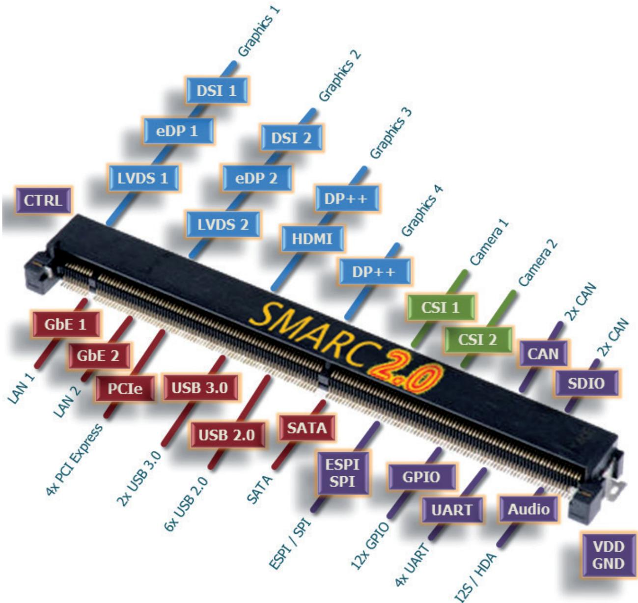
Port, HDMI et DVI. Utilisé en parallèle avec les ports HDMI et LVDS, il devient possible de piloter jusqu'à trois systèmes d'affichage indépendants (pourvu que la plate-forme CPU du module en question puisse effectivement supporter des écrans indépendants triples).
